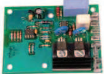
用于单相马达 软启动的PCB板
