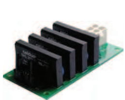
4个SKL固态继电器 安装在PCB板上
